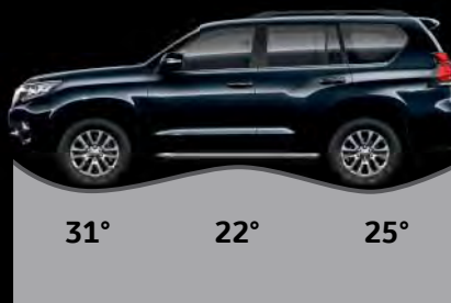
Frigångsvinkel fram, ramvinkel mellan hjulparen och frigångsvinkel bak
